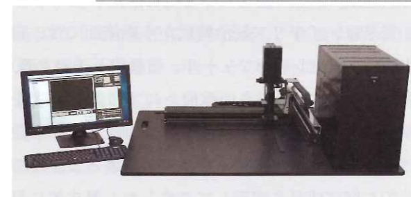
「高精度寸法自動測定装置」(右)と「卓上型寸法自動測定装置」(下)
